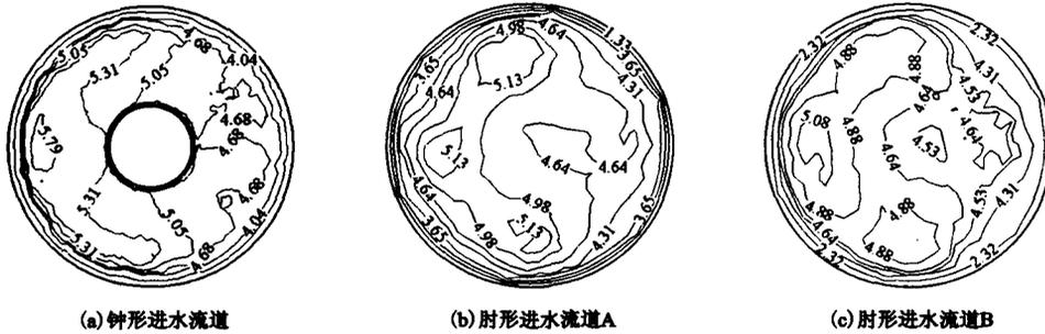
图 4 进水流道出口断面轴向流速分布图 (m/s)
