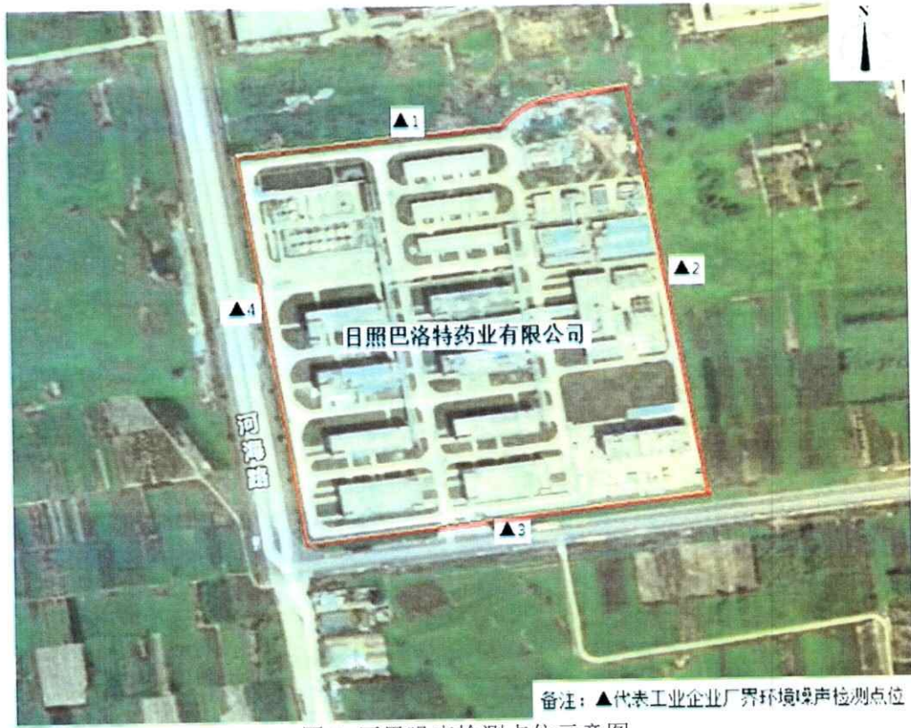
图 1 厂界噪声检测点位示意图
