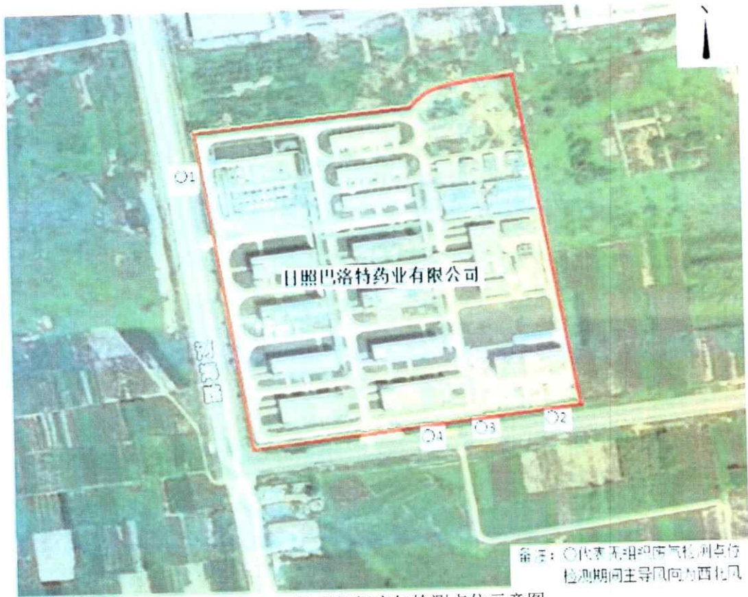
图1 厂界无组织废气检测点位示意图
